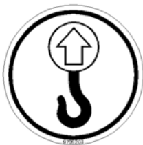
Fig. 4: Señal de ojetes de soporte
