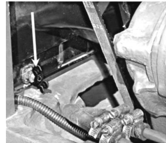
Fig. 5.3.7. Radiator drain tap.
