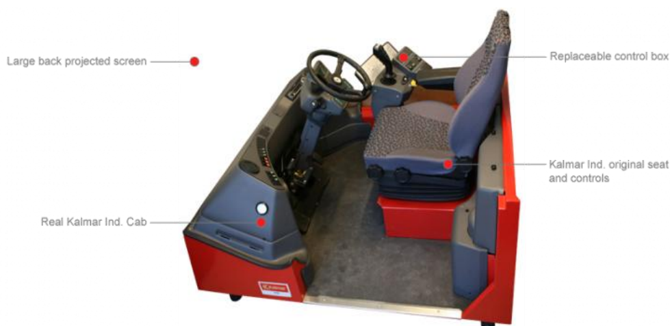
Figura 2 – cabina do equipamento
