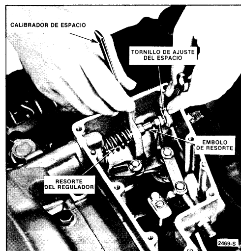
Fig. 1 - Ajuste del espacio del regulador
