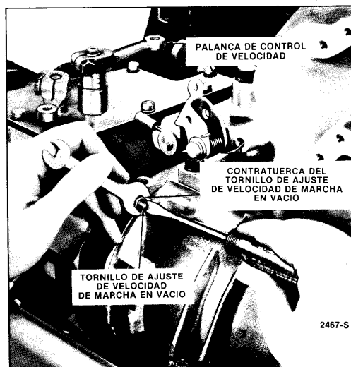
Fig. 5 - Ajuste de la marcha en vacío del motor
