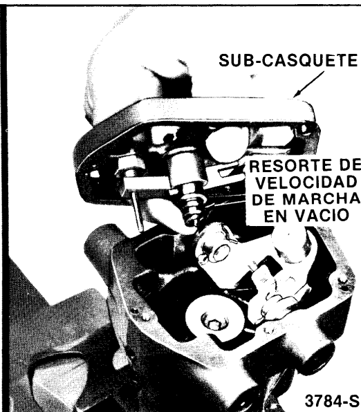
Fig. 11 - Sacando o instalando el conjunto del sub-casquete de un regulador
