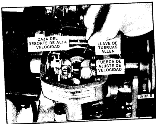
Fig. 12 - Aflojando el tornillo Allen de la caja de resorte
