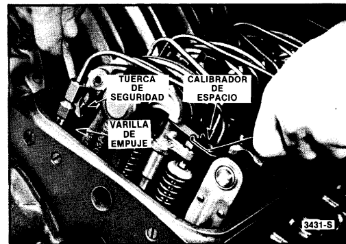
Fig. 3 - Ajustando la tolerancia de la válvula (puente de válvula sin carga)
