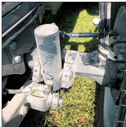
Hidravlična cilindra prednjega hidravličnega dvigala sta pritrjena na prednjo premo.
