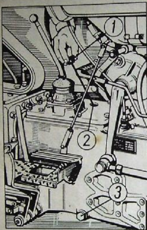
Rys. 24. Smarowanie mechanizmów przekładni i podnośnika hydraulicznego: 1 — korek ze wskaźnikiem płetowym, 2 — otwór wlewowy oleju, 3 — korek spustowy oleju.
