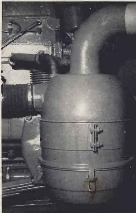
Fig. 3.7. - Filtro de aire en baño de aceite
