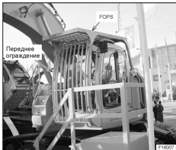
ИСПОЛЬЗОВАНИЕ КОНСТРУКЦИЙ ТИПА FOPS И ПЕРЕДНЕГО ЗАЩИТНОГО ОГРАЖДЕНИЯ
