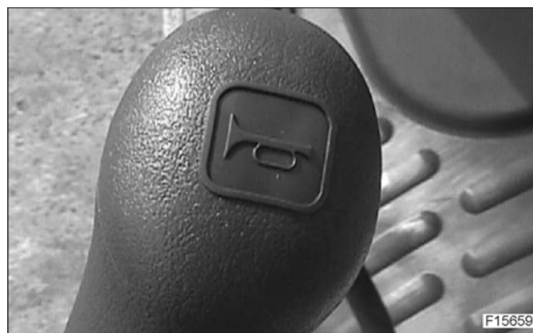
ПЕРЕД ЗАПУСКОМ ДВИГАТЕЛЯ ПОДАЕТСЯ ЗВУКОВОЙ СИГНАЛ
