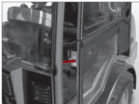
Fig. 25 Door put-up hinges
