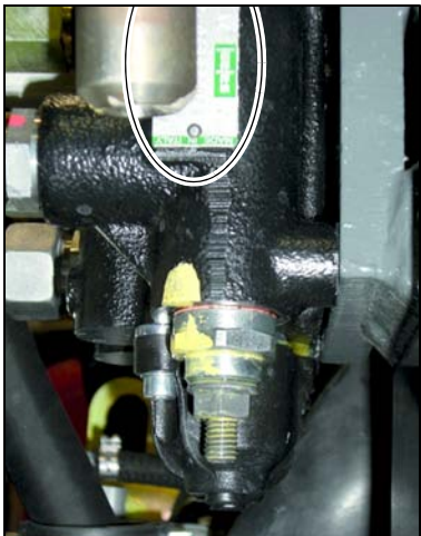
Placa de características corredera de distribución (a partir de AD60001D)
