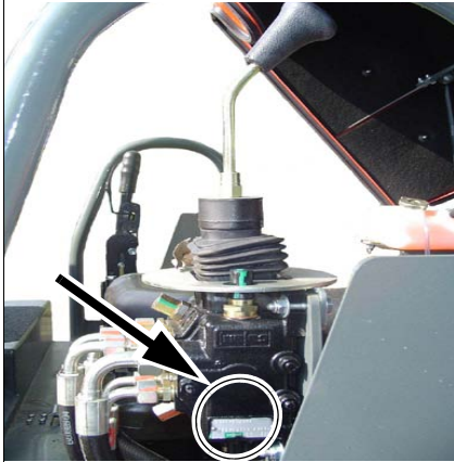
Fig. 7: Placa de características corredera de distribución volquete giratorio
