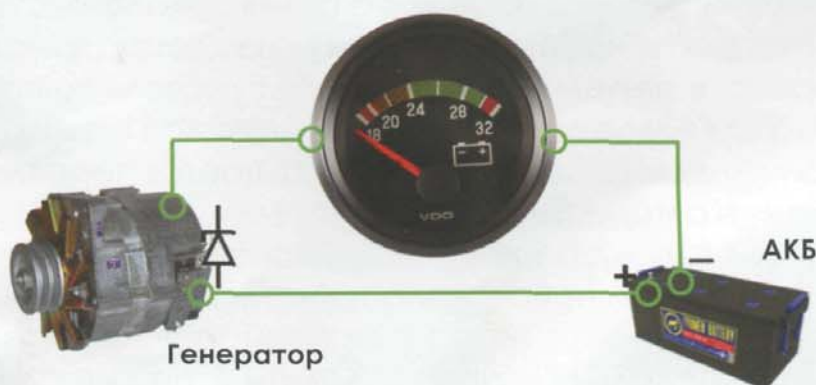
Рис. 12. Схема функционирования генераторной установки
