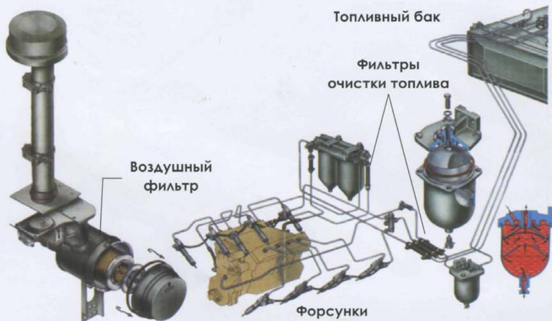
Рис. 4. Схема системы питания автомобиля Камаз-4310
