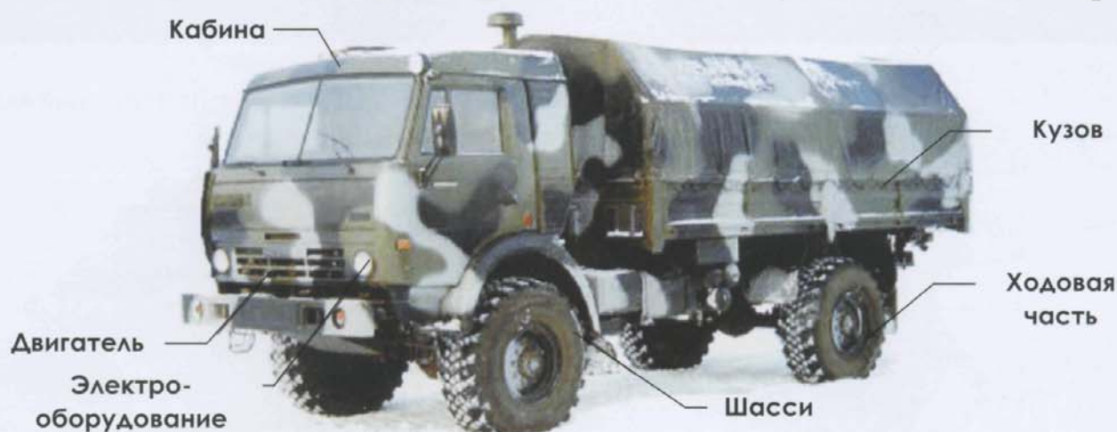
Рис. 2. Общее устройство автомобиля КАМАЗ-4310
