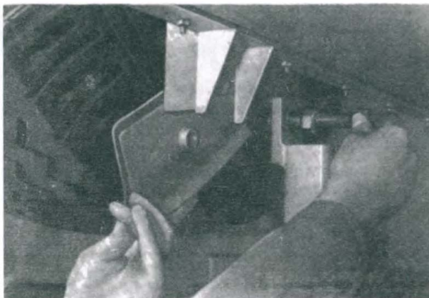
Рис.60 Снятие зажима колеса
