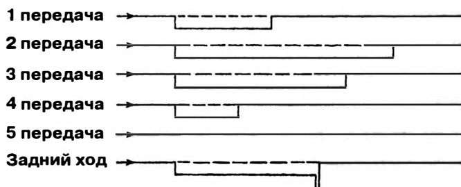
K — схема силового потока; R — задний ход
