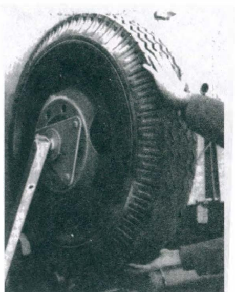
Рис.62 Опускание заднего колеса
