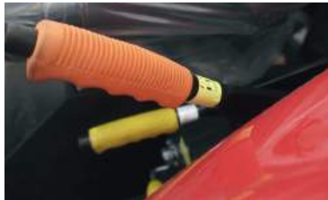
Levier du système à quatre roues motrices
