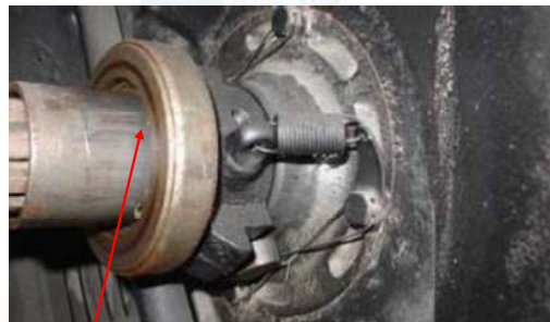
Falta lubricante entre la base del cojinete de separación y la funda. Y se produce desgaste y estiramiento.
