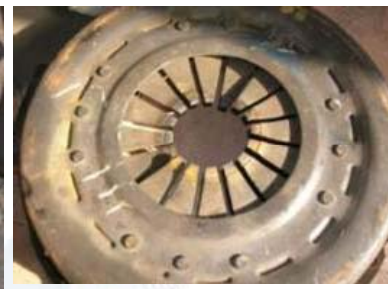
las manecillas de separación de diafragma no están llanas
