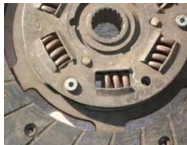
resorte amortiguador rompe
