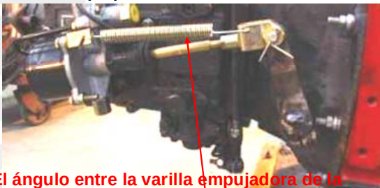
el ángulo entre varillas empujadoras es demasiado pequeño
