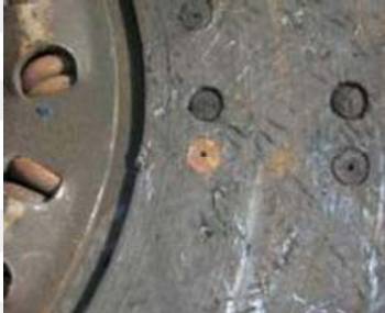
pedazo de fricción se desgasta hasta el roblón
