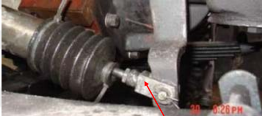
el ángulo entre varillas empujadoras es demasiado pequeño
