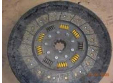
hay mugre en el pedazo de fricción
