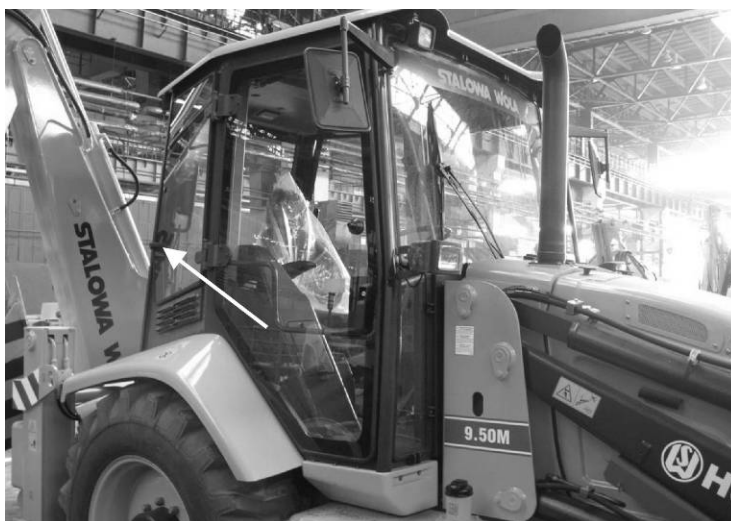
Рис. 4.13. Окно кабины боковое, отклоняемое
