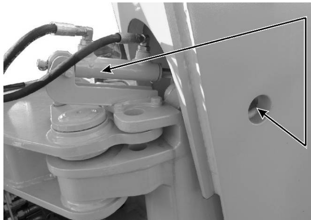
Рис. 5.53. Механизм блокирующий стрелу в поднятой позиции
