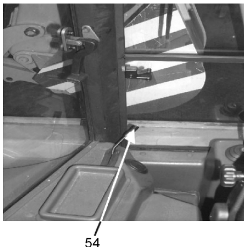
Рис. 4.9А. Рычаг управления оборотами двигателя (подачей топлива)
