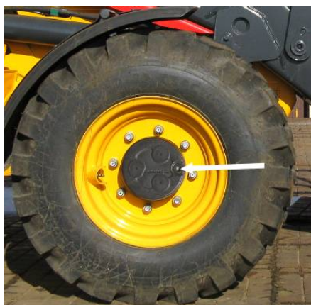
Рис. 5.23. Пробка контрольно-заливного отверстия планетарной передачи
