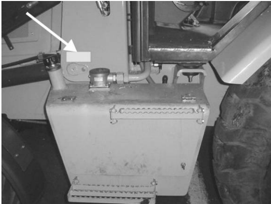
Рис. 1.2. Табличка с данными по машине (фирменная, с серийным номером)
