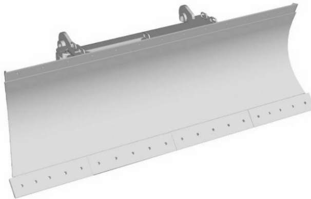
Рис. 6.8. Отвал бульдозерный, универсальный
