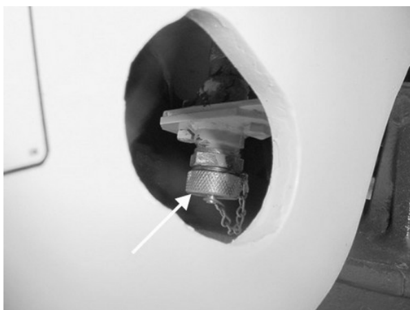
Рис. 5.19. Кран радиатора сливной (с левой стороны машины)
