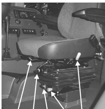
Рис. 4.14. Кресло оператора с амортизацией
