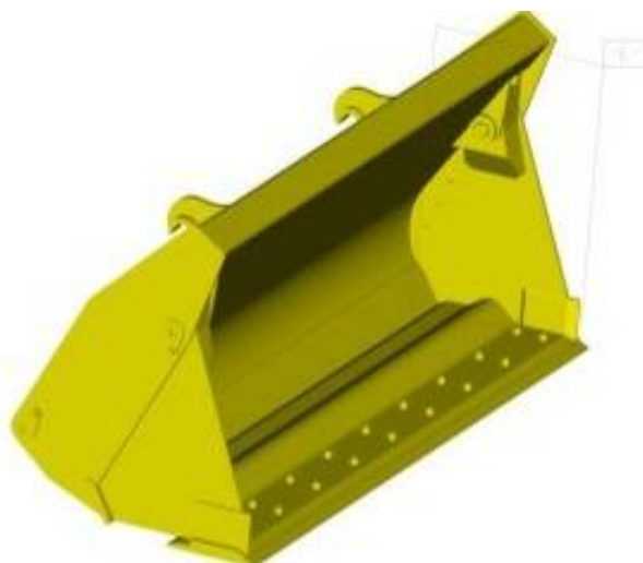
Рис. 6.4А. Ковш многооперационный с режущей кромкой
