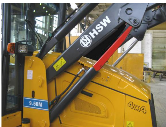
Рис. 5.10. Блокировка поднятой погрузочной стрелы от самопроизвольного опускания
