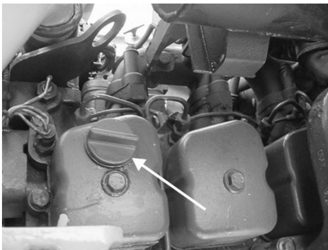
Рис. 5.31. Пробка маслозаливной горловины системы смазки двигателя
