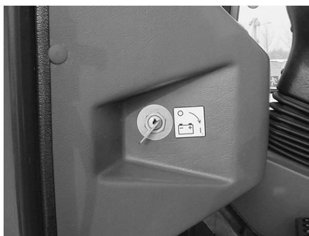
Рис. 4.19. Главный выключатель системы электрооборудования
