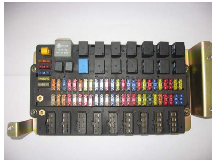
Центральная электрическая распределительная коробка.
