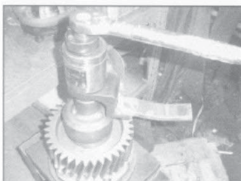
закрепить замочные гайки В30 пневмоударным шепталом. И потом закрутить гайки машиной закручивания, требование крутящего момента 1630Nm.
