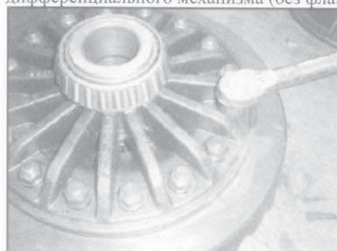
Снимать олуоболочки дифференциального механизма (без фланца)
