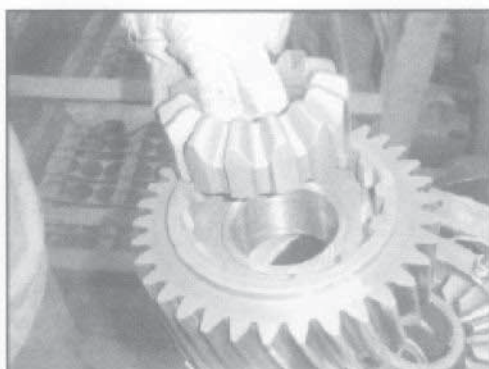
Вынимать полуосесимметричные зубчатки из активных цилиндрических зубчаток(передние)
