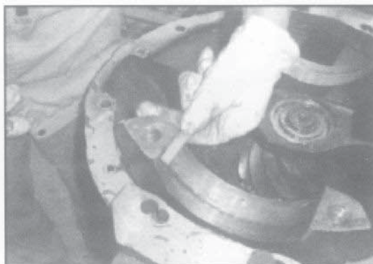
Чистить корпус главного редуктора
