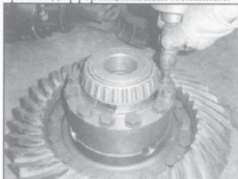
Распустить крепёжные болты для дифференциального механизма
