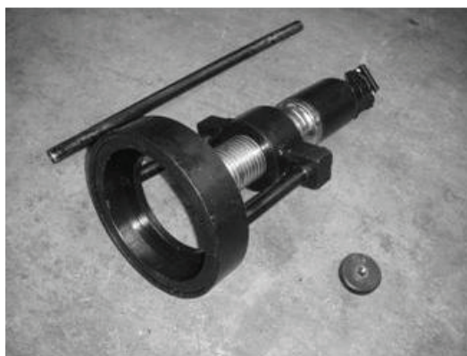
Рис. 17а: Съемник подшипника выходного вала.
