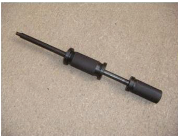
Рис. 6а: Съёмник оси паразитной шестерни.
