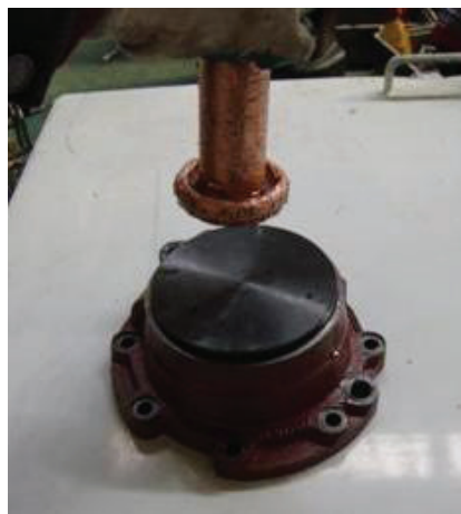
Рис. 11б: Использование оправки для установки уплотнительной манжеты выходного вала
