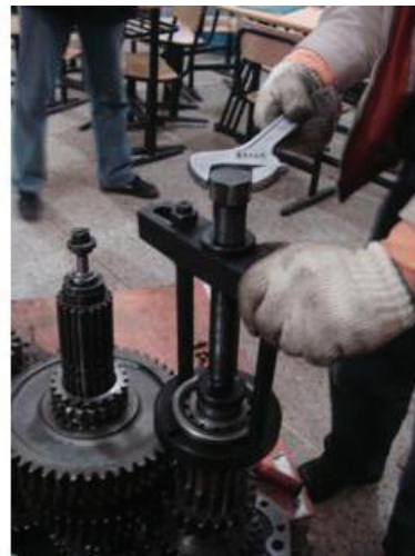
Рис. 5б: Снятие переднего и заднего подшипника с помощью съёмника.
