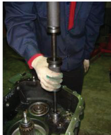
Рис. 6б: Использование съёмника при снятии оси паразитной шестерни.
