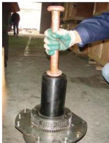
Рис. 9b: Использование кольцевой оправки при установке водила планетарного механизма
