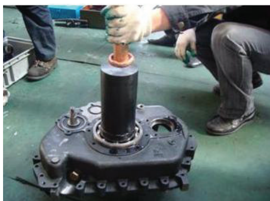
Рис. 9с: Использование кольцевой оправки при установке подшипника входного вала
