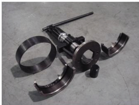
Рис. 4а: Съемник конусной ступицы синхронизатора высшей передачи
