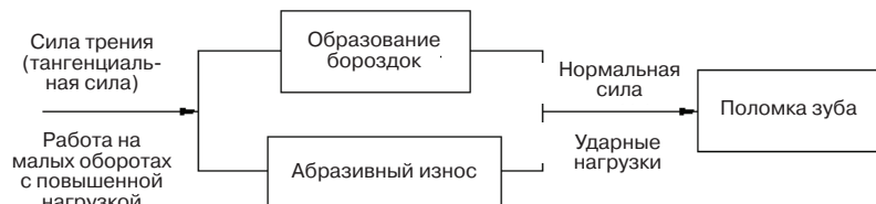
Рис. 5-4. Критический износ шестерен
