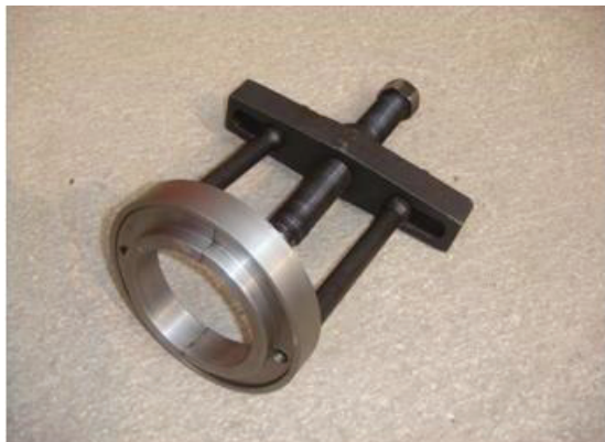
Рис. 5а: Съёмник подшипников промежуточных валов
