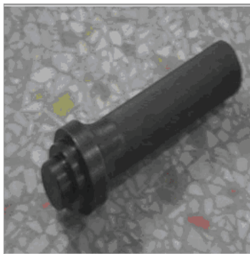
Рис. 12а: Оправка для установки уплотнительных манжет торцевой крышки малого картера
