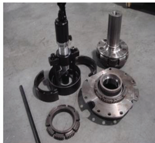
Рис. 4д: Снятая зубчатая муфта синхронизатора
