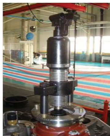
Рис. 16b: Снятие фланца при помощи съёмника.
