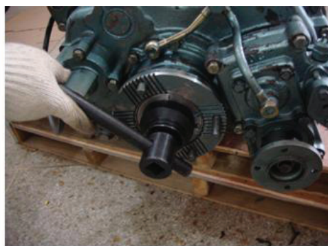
Рис. 14b: Использование головки для гайки фланца совместно с рычагом
