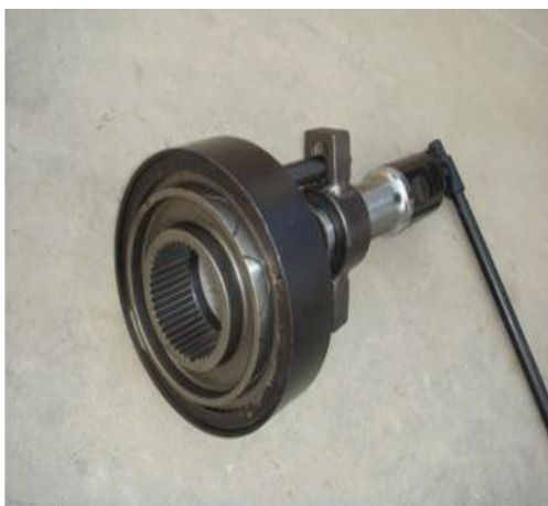
Рис. 4с: Снятая конусная ступица синхронизатора высшей передачи
