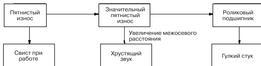
Рис. 5-6. Процесс износа подшипников
