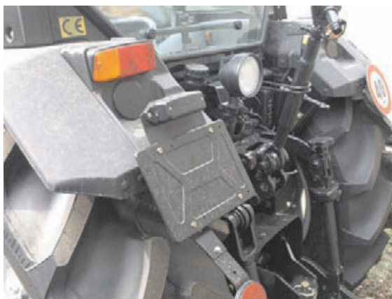
Elevador hidráulico y acoplamiento de tres puntos
