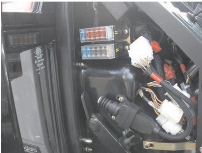
Lado izquierdo del salpicadero: caja de fusibles
