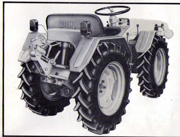
FIG. 10 Enganche graduable neces- ario para obtener los distin- tos puntos de regulación in- dispensables para una bue- na labor de arado.
