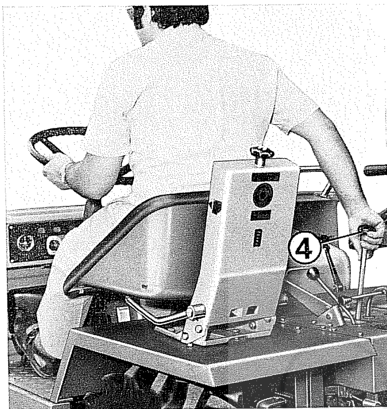
Fig. 3 - Inserimento del riduttore-invertitore
