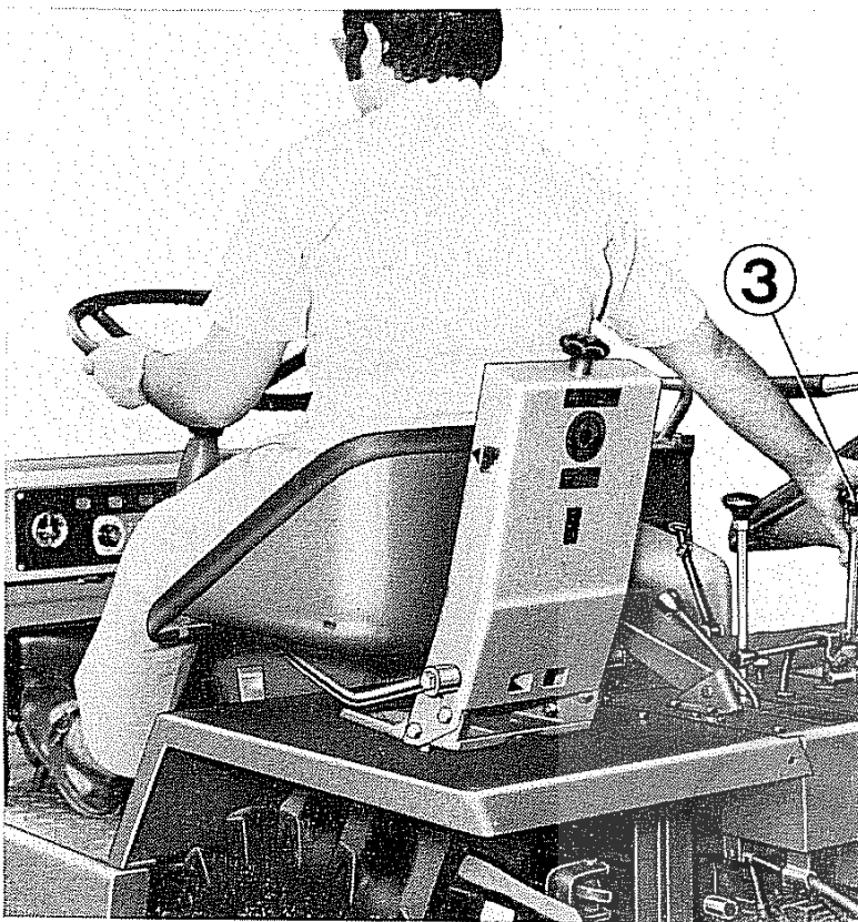
Fig. 4 - Innesto delle velocità
