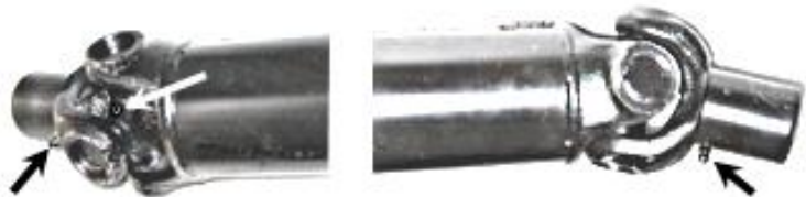
Fig. 5.6.7. Propeller shaft – 2 grease points
