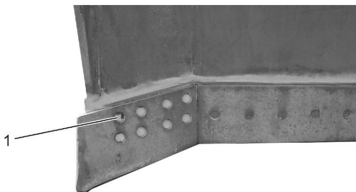
Рис. 5.41. Подтягивание болтов крепления режущих кромок отвала
