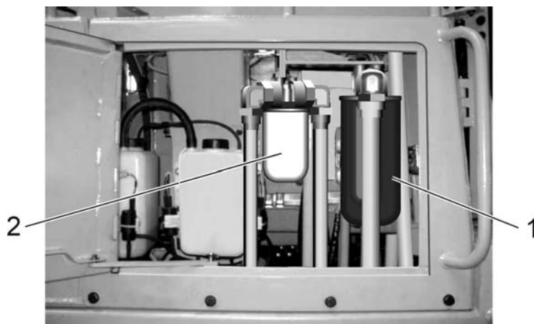
Рис. 5.24. Возвратный фильтр и фильтр управления
