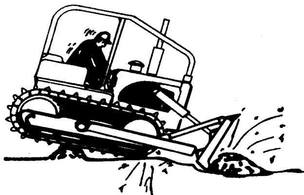
Рис. 4.32. Сталкивание перерабатываемого материала вниз под уклон
