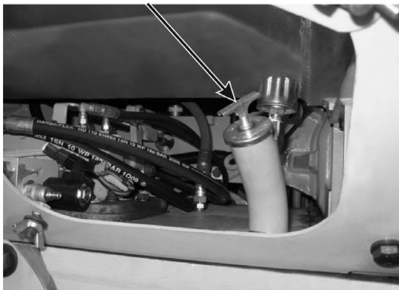
Рис. 5.44. Проверка уровня масла в задней части главной рамы (мерный щуп)
