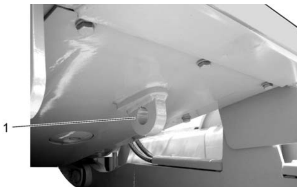
Рис. 3.4. Расположение буксирного крюка на машине
