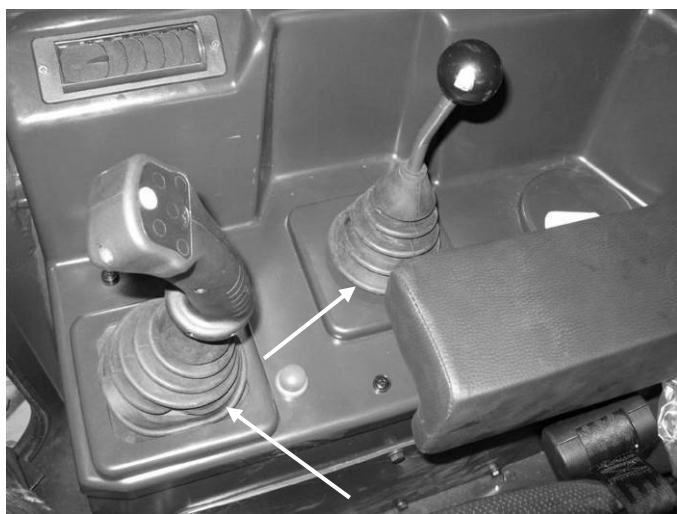
Рис. 5.30. Смазка наконечников толкателя клапанов управления
