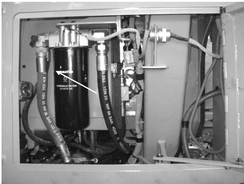
Рис. 5.46. Фильтр приводной системы
