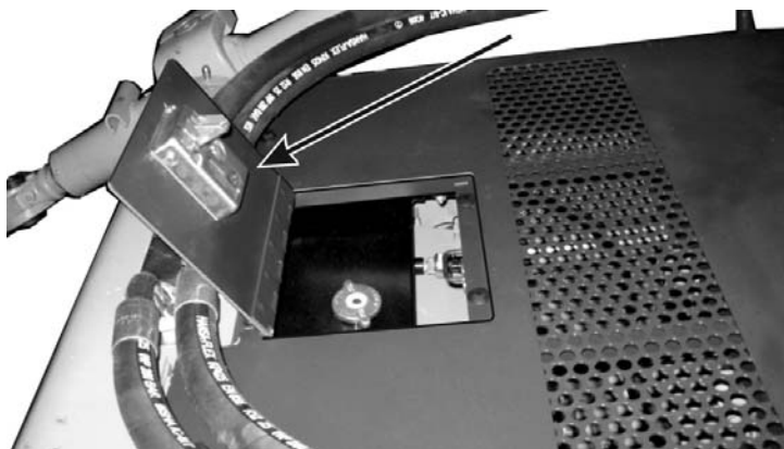
Рис. 5.6. Пробка заливной горловины радиатора
