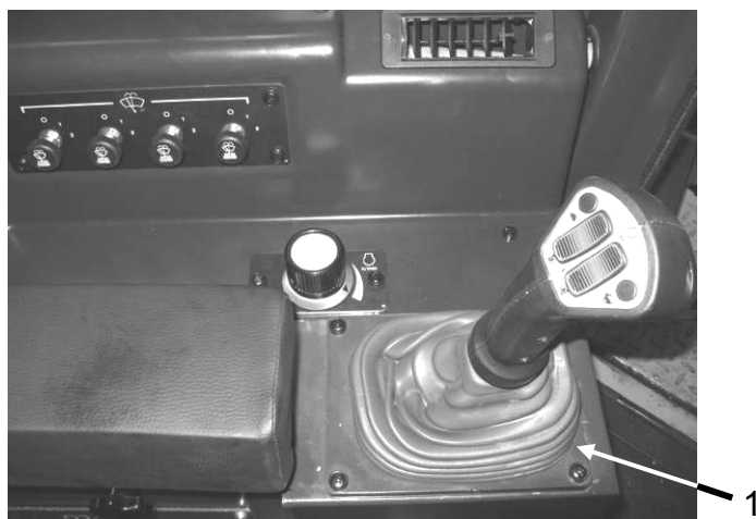
Рис. 5.29. Смазка наконечников толкателей клапанов управления системой привода (движения)
