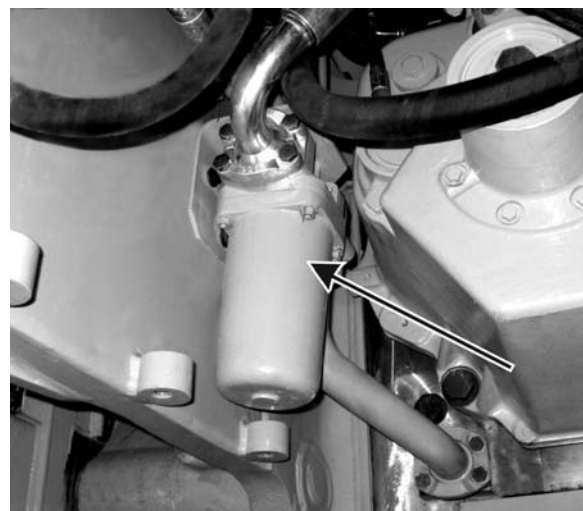
Рис. 5.48. Размещение всасывающего фильтра
