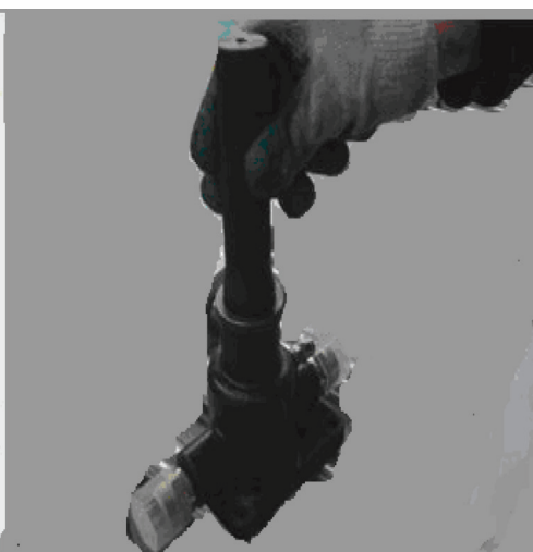
Рис. 12b: Использование оправки для установки внутренней уплотнительной манжеты торцевой крышки малого картера
