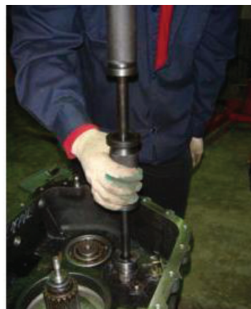
Рис. 6б: Использование съемника при снятии оси паразитной шестерни.
