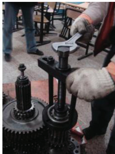
Рис. 5б: Снятие переднего и заднего подшипника с помощью съемника.а
