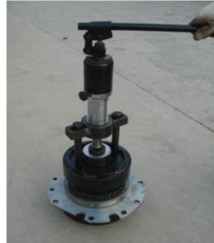
Рис. 4б: Используйте съемник для снятия конусной ступицы синхронизатора или зубчатой муфты синхронизатора.
