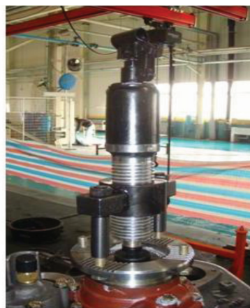
Рис. 16b: Снятие фланца при помощи съёмника.
