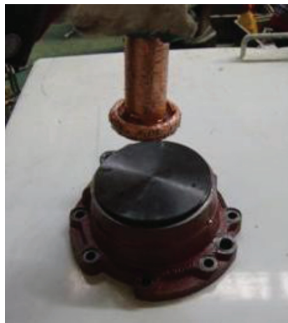
Рис. 11b: Использование оправки для установки уплотнительной манжеты выходного вала
