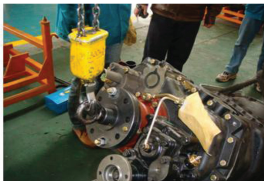
Рис. 2б: Подъем коробки передач при помощи подвеса.
