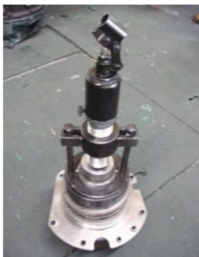
Рис. 17б: Снятие подшипника выходного вала при помощи съемника.
