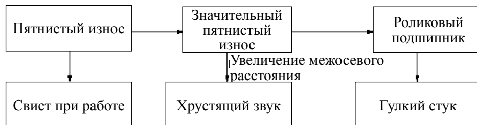
Рис. 5-6. Процесс износа подшипников
