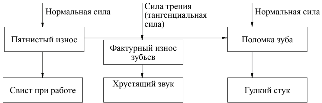
Рис. 5-3 Процесс износа зубьев при нормальной эксплуатации
