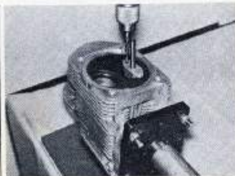
Extraction d'un siège de soupape par perçage à l'aide de la broche de guidage.
