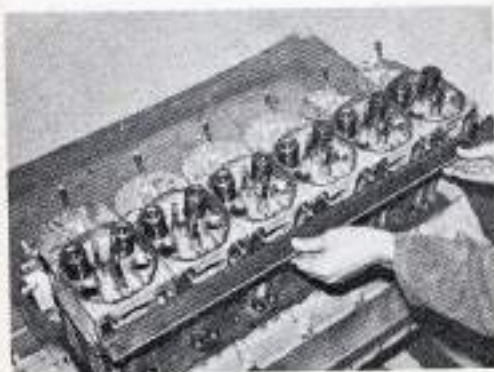
Alignement des culasses sur le moteur FEL912.
