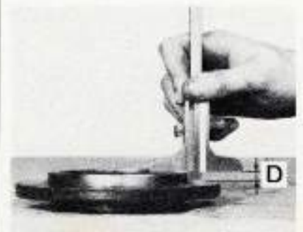
Mesure du couvercle inférieur.
