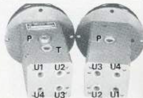
Identification des orifices sur le manipulateur. P. Orifices de retour. - U1, U2, U3, U4. Orifices raccordés aux distributeurs. T. Orifice d'alimentation.
