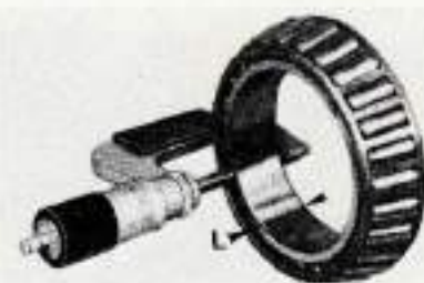
Relevé de l'épaisseur de la cage intérieure du roulement côté pignon conique de l'inverseur. L. Épaisseur du roulement.
