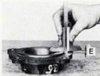
Mesure du couvercle supérieur. E. Hauteur de la collerette.
