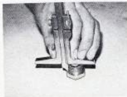
Mesure de la hauteur du bouchon fileté (ancien montage).
