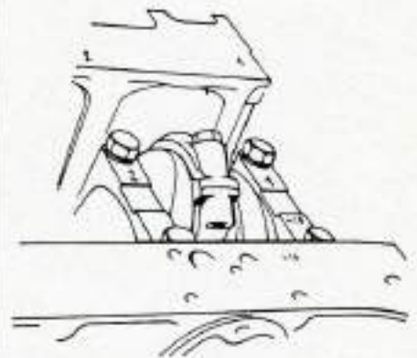
Repérage des chapeaux de paliers.
