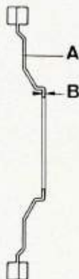
Relevé de l'épaisseur de la turbine. A. Turbine. B. Epaisseur de la turbine.
