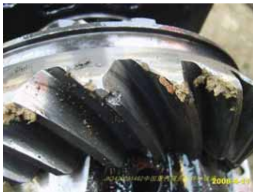
Рис. 2-27 Излом зубьев конического зубчатого колеса
