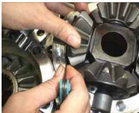
(5) Проверьте зазор (от 0,6 до 1,0 мм)
