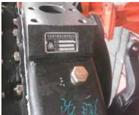
Процедура 12: Установка концевой крышки колеса и заклепывание таблички.
