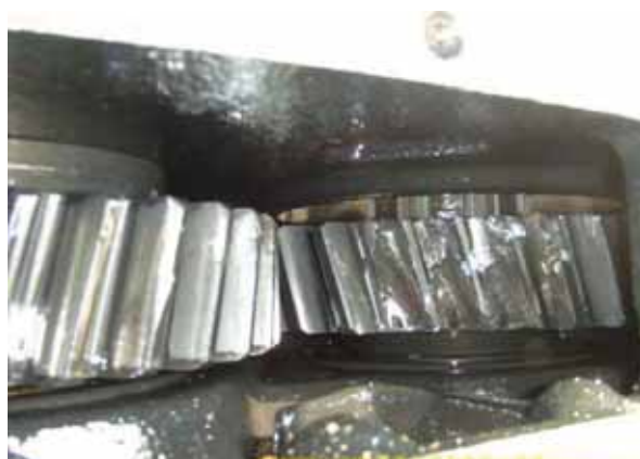
Рис. 2-28 Излом зубьев ведущего или ведомого цилиндрического зубчатого колеса
