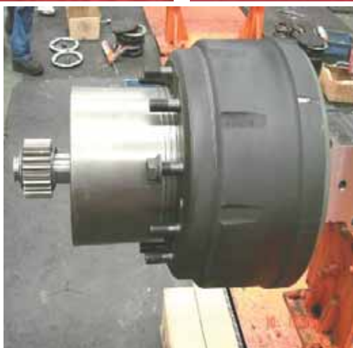
Процедура 10: Установка полуоси и солнечной шестерни
