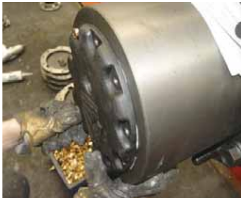
Процедура 12: Установка концевой крышки колеса и заклепывание таблички.
