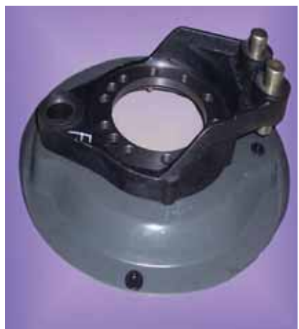
Процедура 2: Установка задней опорной плиты тормоза в сборе и уплотнения полуоси
