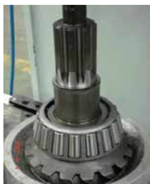
(4) Установите подшипник ведущей вал-шестерни
