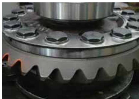
(2) Установите фиксирующие элементы и подшпипник
