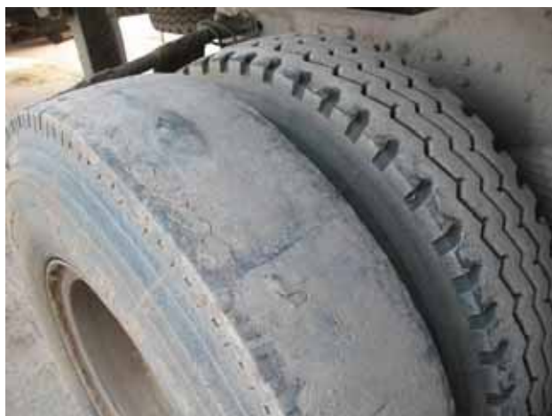
Рис. 2-24 Несимметричный износ шин вследствие деформации картера моста
