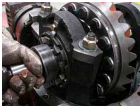
(14) Установите неподвижную зубчатую полушестерню блокировки (момент затяжки равен 200~240 Н•м).
