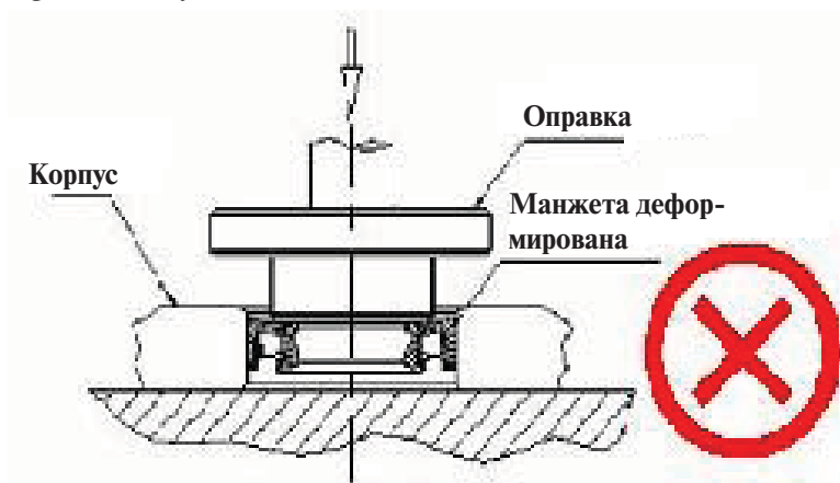
Рис. 2-8 Внутренний диаметр оправки слишком мал
