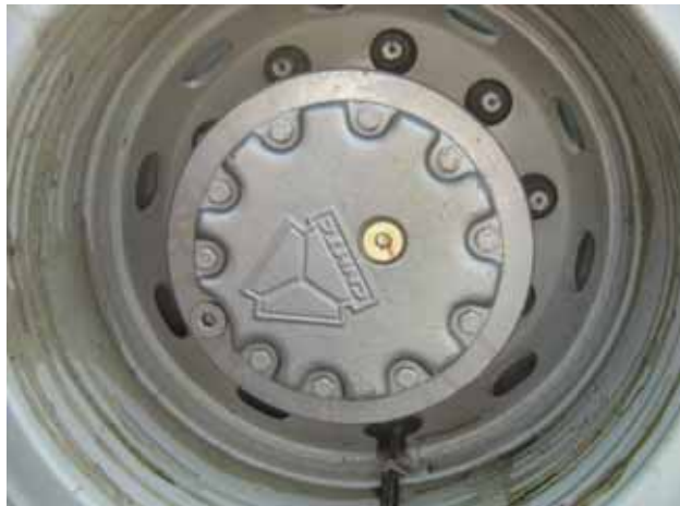
Рис. 2-12 Утечки через песчаные раковины
