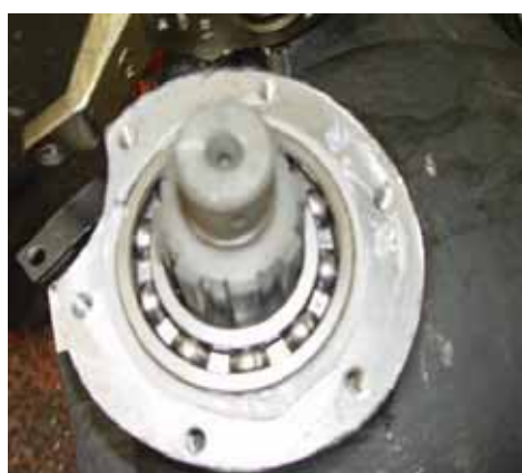
Процедура 13: Установка вала, соединяющего приводы двух ведущих мостов; блока подшипников и фланца
