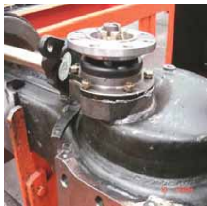
Процедура 13: Установка вала, соединяющего приводы двух ведущих мостов; блока подшипников и фланца
