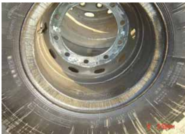
Рис. 2-11 Утечки через песчаные раковины
