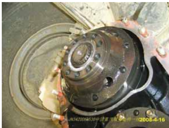
Рис. 2-30 Излом деталей на входе в межосевой дифференциал
