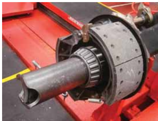
Процедура 6: Установка разделительного кольца и подшипников ступицы колеса
