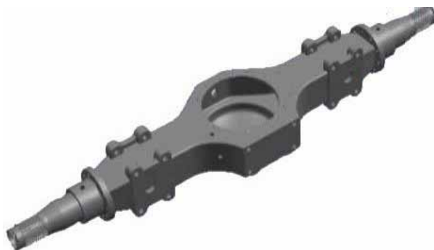
Рис. 1-16 Трехсекционный картер ведущего моста серии STR
