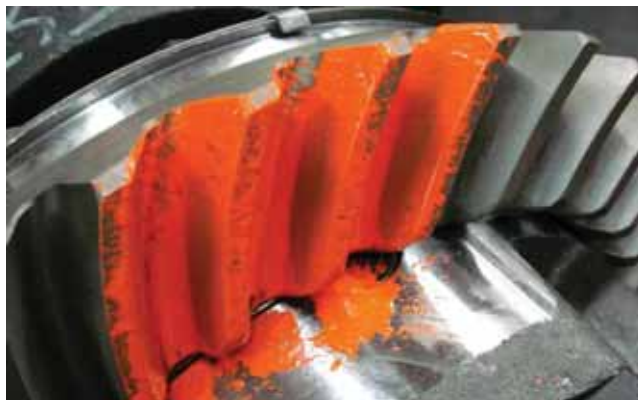
Рис. 2-25 Коррекция пятна контакта конической шестерни
