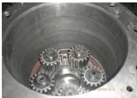
(3) Проверьте сборку механизма колесного редуктора
