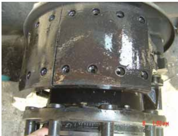
Рис. 2-33 Масляное пятно на тормозной накладке
