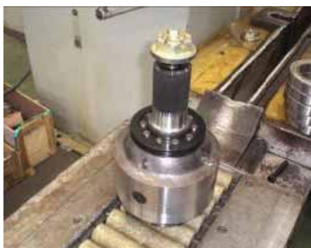
(8) Установите кольцо со штифтами блокировки дифференциала
