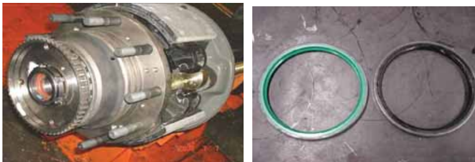
Процедура 7: Установка задней ступицы, кронштейна и зубчатого колеса
