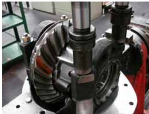
(12) Затяните гайки крышки до момента 210~260 Н•м.
