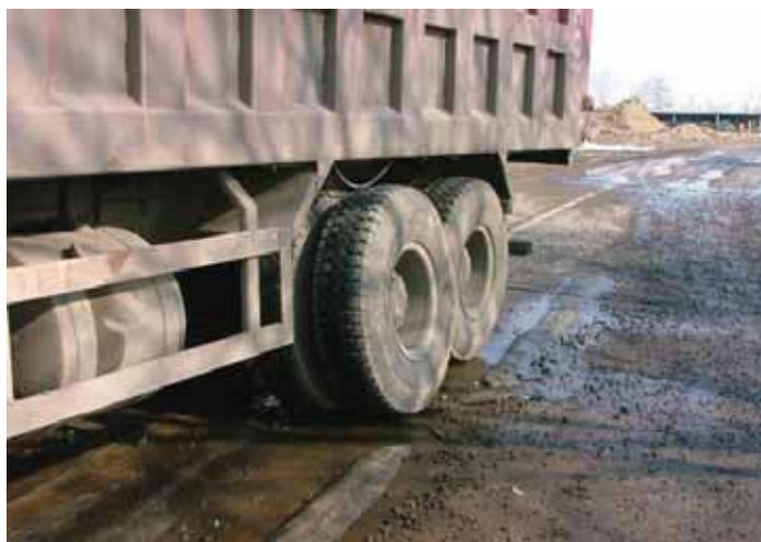
Рис. 2-14 Биения головки литого корпуса трехсекционного моста
