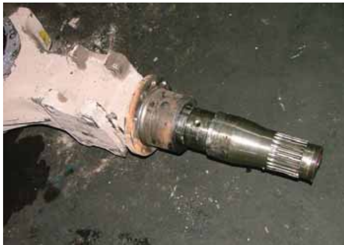
Рис. 2-13 Биения головки литого корпуса трехсекционного моста
