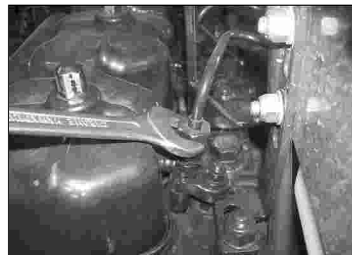
A-Fuel Return Line B-Hand Primer
