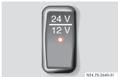
Comutatorul transformatorului de tensiune
