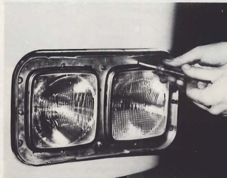
Fig. 14.2. — Tornillo de reglaje de los faros
