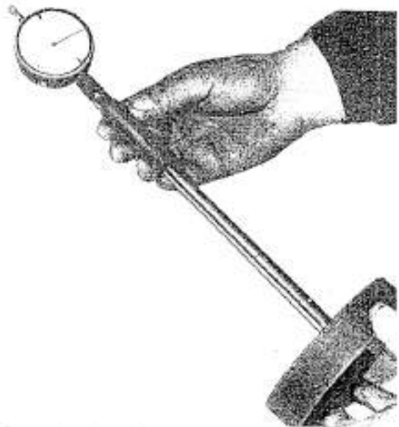
FIG. 9 - Emploi de la cale-étalon
