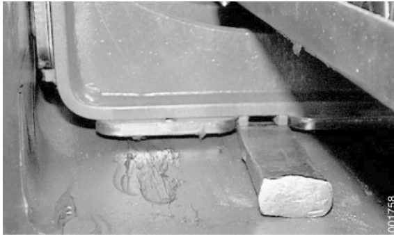
La figura muestra las placas deslizantes interiores en la viga principal del implemento.
