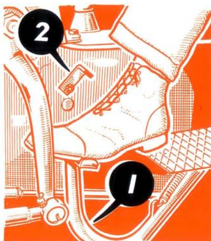
FIG. 6 B. — Pédale de débrayage (1) avec butée (2) libérant la course totale.
