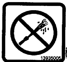
تصویر ۱۶: از پاشیدن آب به ورودی هوا خودداری نمایید. Fig. 16 Avoid directing water jet against air intake
