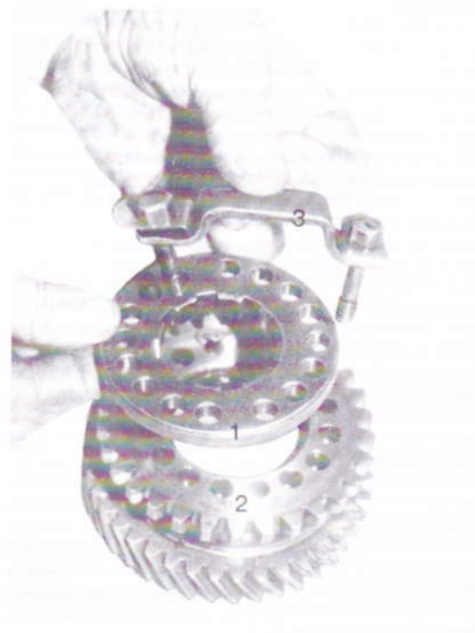
39. ábra. A befecskendezőszivattyút hajtó fogaskerék szerelése 1. hornyos karima, 2. kettős fogaskerék, 3. ütközőlemez
