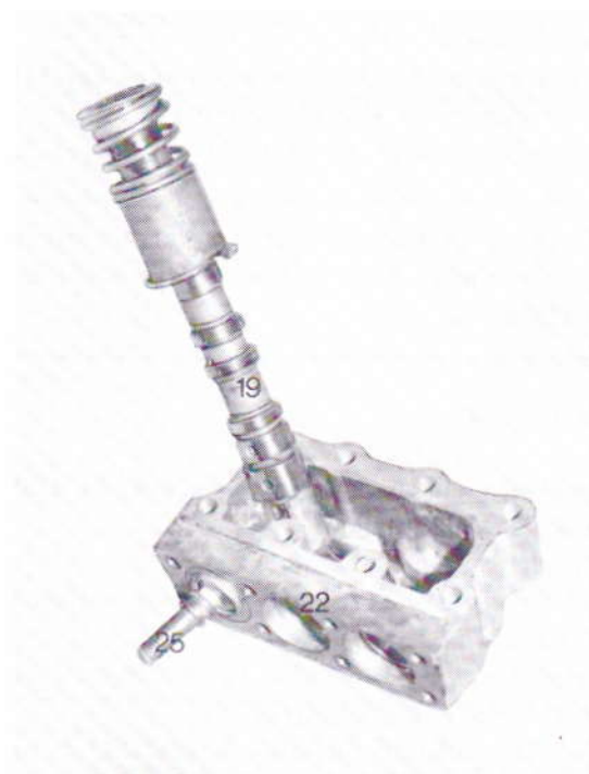
126. ábra. Szerelt tolattyú az alsó fedéllel 19. tolattyú, 22. alsó fedél, 25. kapcsolókar
