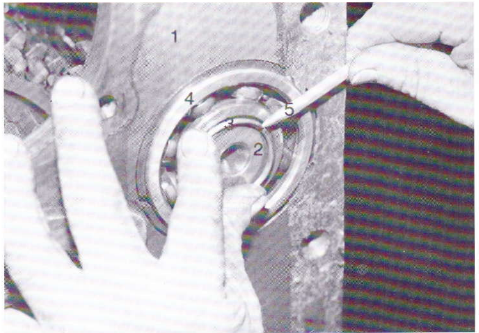
69. ábra. Az I. és hátrameneti fokozat tengelyének kiserelése
