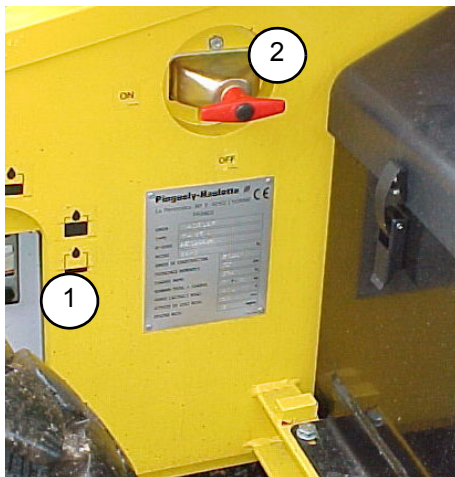
Photo 9 - Coupe batterie - Niveau
