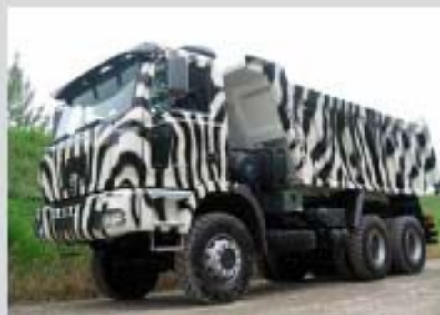
▲ HDM 6x4 rock body / benne roche
