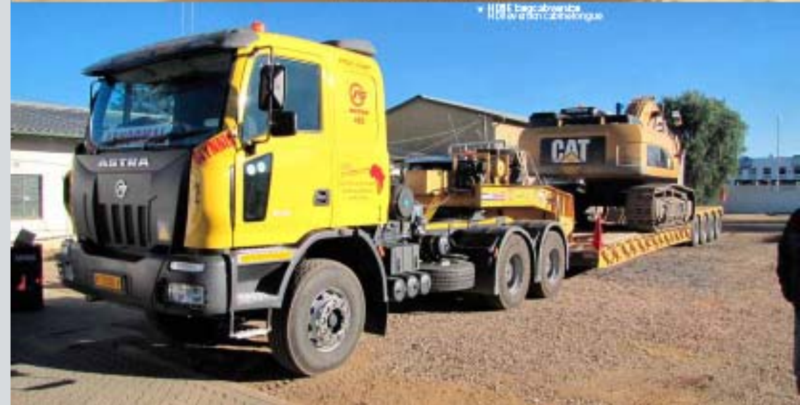
▲ HD8 desert version with speed of wheel and high flotation HD8 version avec vitesse de roue et haute flottabilité
