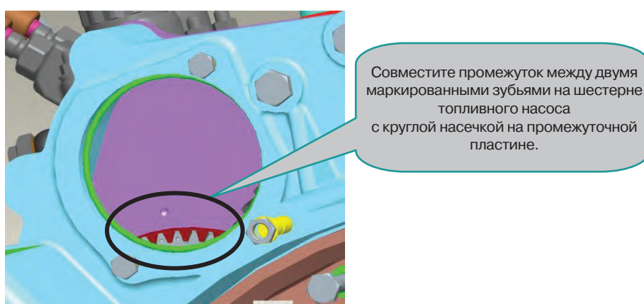
Рис. 21. Установка топливного насоса
