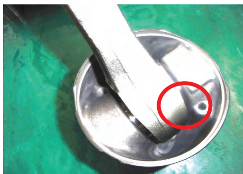
Рис. 3. Предварительная установка шатунной группы поршня
