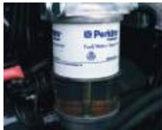
Filtre de retenue d'eau
