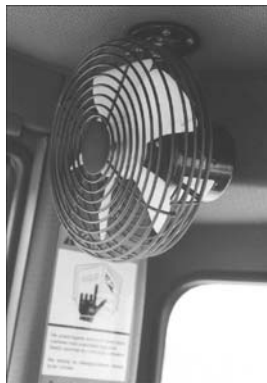
Рис. 4.9. Вентилятор кабины (обдув переднего стекла воздухом для предотвращения его обледенения или запотевания)
