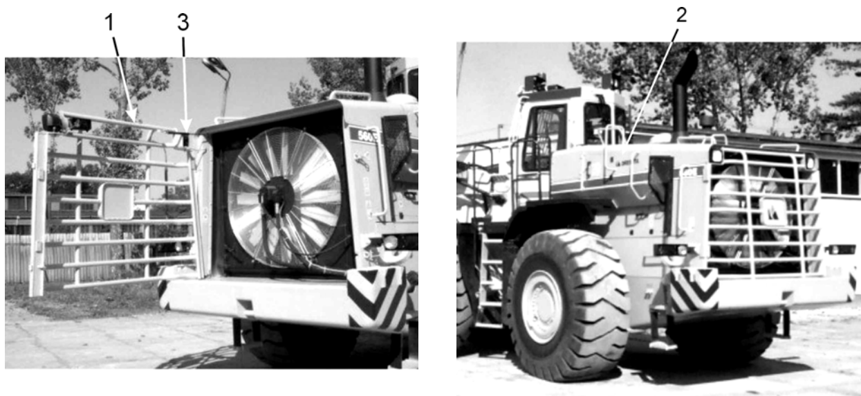
Рис. 5.55. Маска двигателя с открытыми защитными ограждениями
