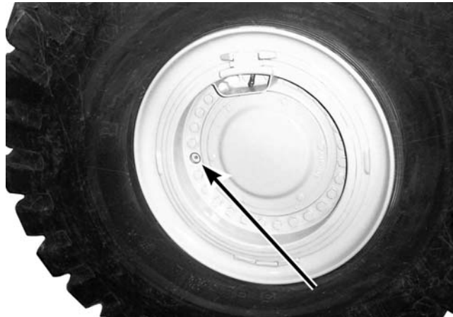
Рис. 5.25. Пробка сливного и контрольного отверстия в мосту
