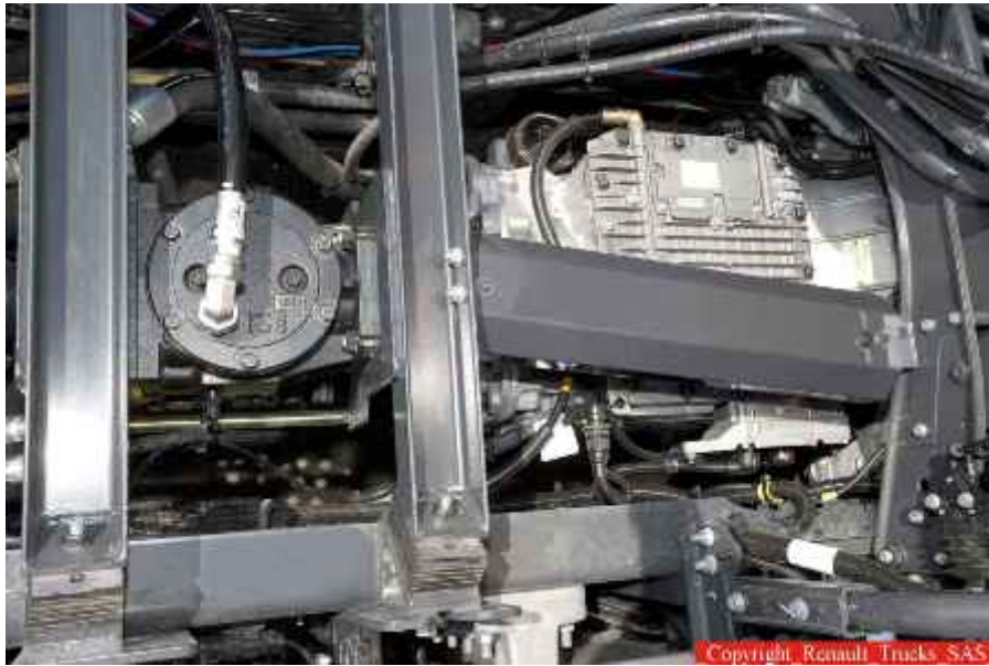
Une tôle protège l'arbre à cardans qui relie le moteur à la pompe hydrostatique.
