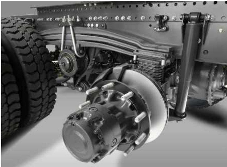
Double pont moteur suspendu par ressorts paraboliques en balancier. Cette disposition conventionnelle à pivot central équilibre la charge sur les deux essieux. Des freins à disque sont montés sur les Premium Lander.
