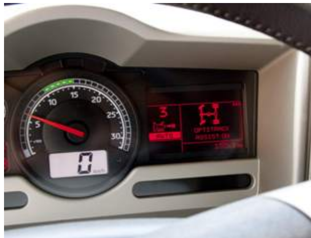
La zone verte du compte-tours indique la plage de consommation minimale sous pleine charge – c'est-à-dire accélérateur à fond. Lorsque la charge est faible, le régime devrait autant que possible être abaissé encore plus.
