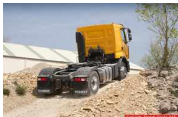
OptiTrack enclenché, la rampe est gravie sans qu'une roue patine.
