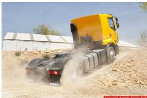
Différentiel bloqué mais sans OptiTrack, le tracteur patine et ne parvient pas en haut de la rampe.
