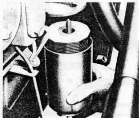
Fig. 31 = Dépose de l'élément filtrant du filtre à huile
