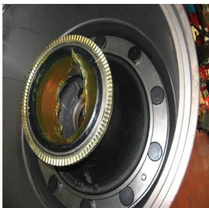
Рис. 2-2. Сборка передней ступицы со ступицей тормозного механизма
