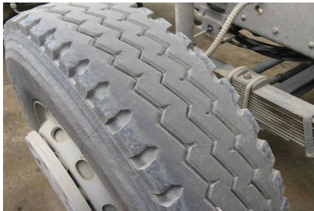
Рис. 4-1 Отклонение переднего колеса от требуемого положения
