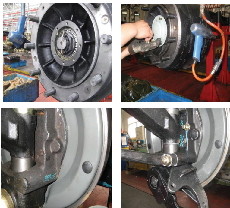
Рис. 2-17 Установка защитной крышки и защитной втулки ABS
