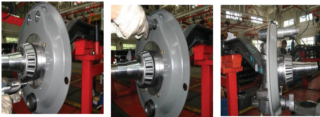
Рис. 2-13 Регулировка угла поворота колеса
