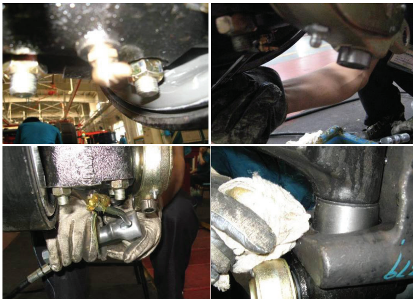
Рис. 2-19 Нагнетание смазки и протирка компонентов моста.
