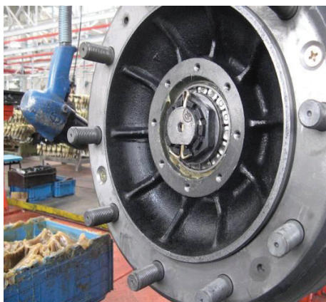
Рис. 2-3. Установка уплотнительной манжеты и зубчатого колеса системы ABS
