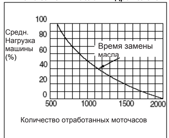
Схема замены масла в гидромолоте
