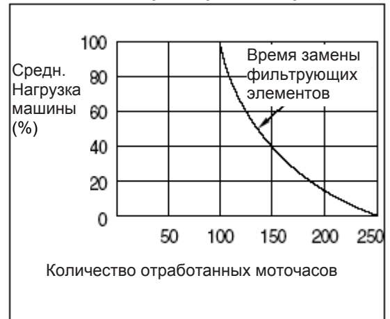
Схема замены масла в гидромолоте
