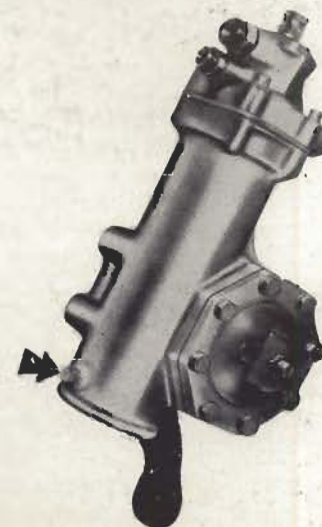
Fig. 10.4. - Tapón de drenaje
