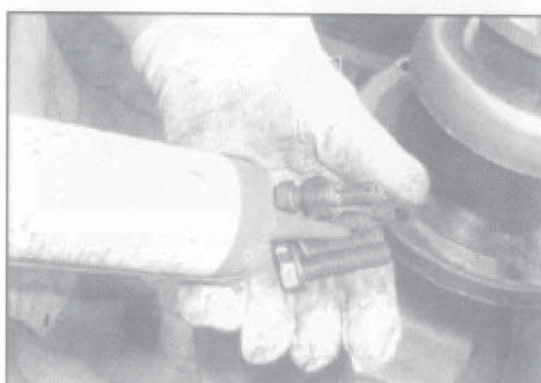
Намазать герметик "Летай518" на болты
