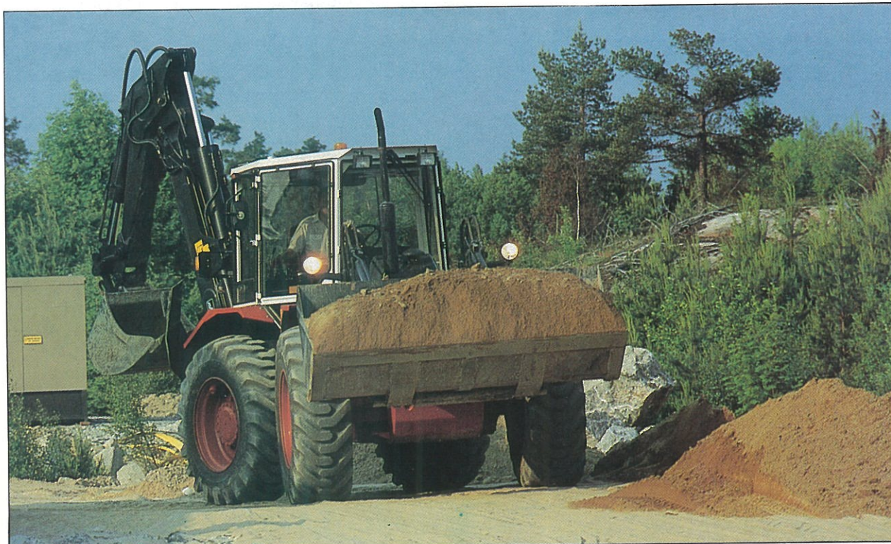
54° vid praktiskt bärläge ger litet materialspill.
