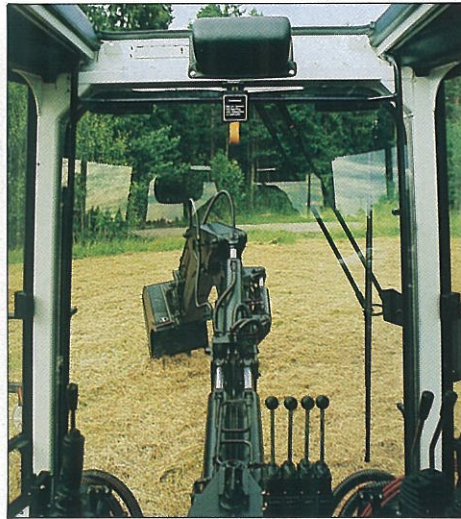
Den uppfällbara bakrutan löper i glidskenor i hyttens undertak.
